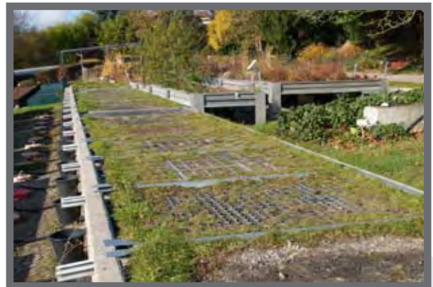
Bild 1: 7 auf einen Streich: Sechs begrünbare Flächenbefestigungen und ein Belag aus Dränbetonsteinen im Parkplatztest - Können die Befestigungsvarianten bei der Bewirtschaftung des Niederschlagswassers auf Dauer mit einer versickerungsaktiven Rasenfläche mithalten?
