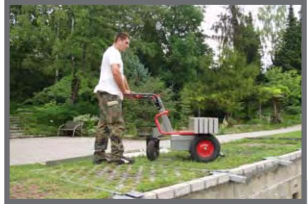
Bild 2: Braucht zwar keine Fahrerlaubnis, ermöglicht aber trotzdem eine Simulation der Parkvorgänge mit 0,5 t Achslast, dreimal pro Tag und das ganze Jahr über.
