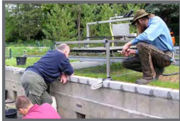
Bild 3: Der Regenmacher: Ohne parzellengenaue Beregnung mit definierten Niederschlagsmengen keine abgesicherten Abflusswerte.
