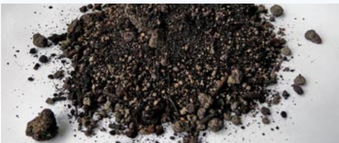
Substrat zur Befüllung für TTE® direct green: Lava 0-3 mm (Bindung von Nitrat und Wasser), Torf (Wasserbindung und luftige Struktur), Holzkompost.
